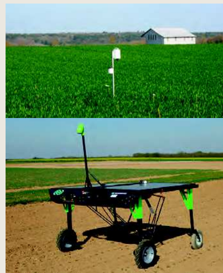
R&D sur la Digifermes ® de Boigneville. En haut, test des piquets connectés Bosch-Hiphen pour le suivi de la croissance des cultures (programme IOF2020). En bas, test du robot désherbeur Ecorobotix sur betteraves (start-up suisse).
